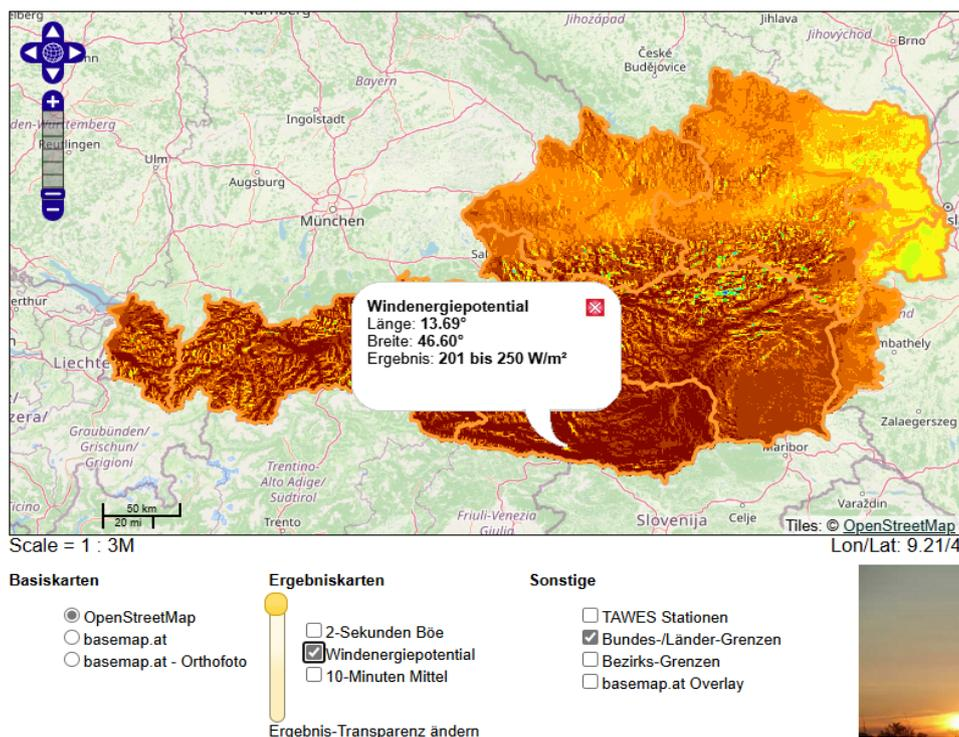
Abbildung 26: Windenergiepotential und Windgefährdung – Kämme (vgl. ZAMG, 2024)
